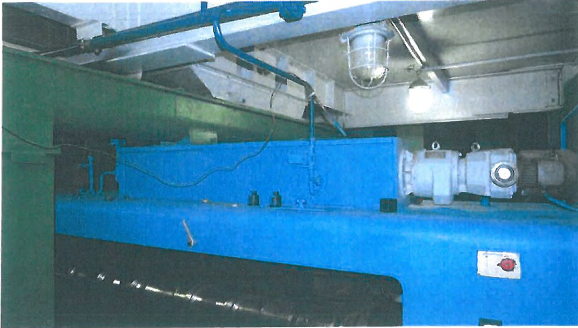
Dosierschnecke mit Handverstellung der Dosierung
