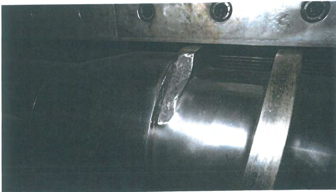
beschädigte Schnecke (hält aber problemlos bis zum vollständigem Verschleiß)
